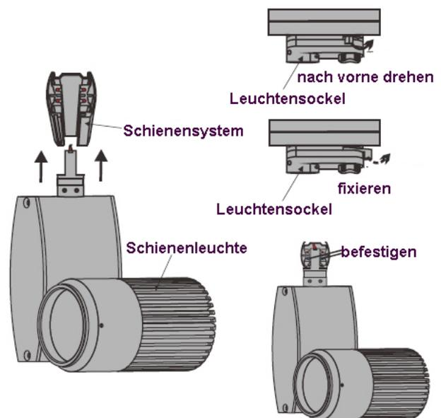
5. Nach der Fixierung den Drehschalter auf einen der 3 Stromkreise schalten
