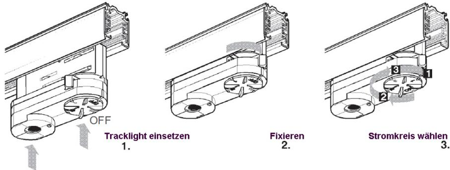
2. Drehschalter des Leuchtensockels auf einen anderen Stromkreis drehen
