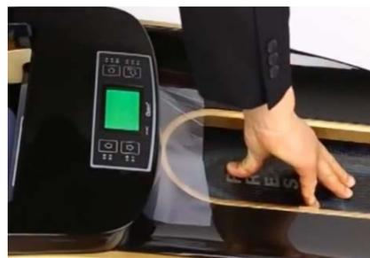
Folie einlegen, so, dass der Rollenanfang von unten nach oben führt und nach vorne zum Gerät zeigt
