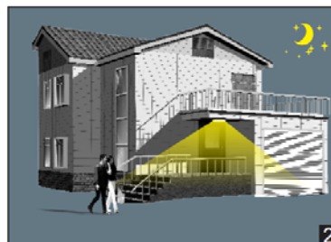
bei unzureichender Helligkeit schaltet der Sensor bei Bewegungserkennung
