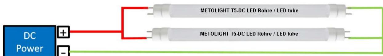
Bei mehreren T5-DC-Röhren: Grundsätzlich paralleler Anschluss, niemals seriell!
