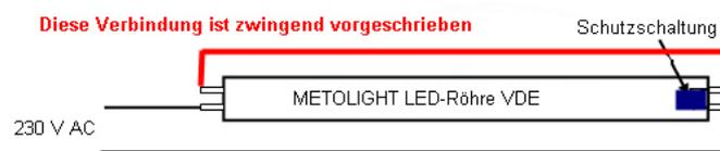
An jeder umgebauten Leuchte müssen Prüfungen erfolgen, die nachweisen, dass die Leuchte sicher ist. Es wird empfohlen, DIN VDE 0701-0702 „Prüfung nach Instandsetzung, Änderung elektrischer Geräte — Wiederholungsprüfung elektrischer Geräte — Allgemeine Anforderungen für die elektrische Sicherheit“ anzuwenden. Die umgebaute Leuchte muss mit einem neuen Typenschild versehen werden.
