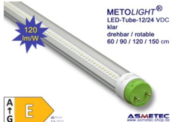
Die LED-Röhre SCE 12/24 wird in ungefährlicher Niederspannung 12 VDC oder 24 V DC betrieben. Die Energieversorgung erfolgt einseitig an der entsprechend gekennzeichneten Endkappe. Die gegenüberliegende Endkappe ist elektrisch nicht beschaltet und dient nur zur Halterung der Röhre in der G13-Fassung. Eine Stromverschleppung von einem zum anderen kontaktende ist somit ausgeschlossen. Die **METOLIGHT®** LED-Röhre SCE-12/24 entspricht im Aufbau den aktuellen Sicherheitsrichtlinien des VDE.
