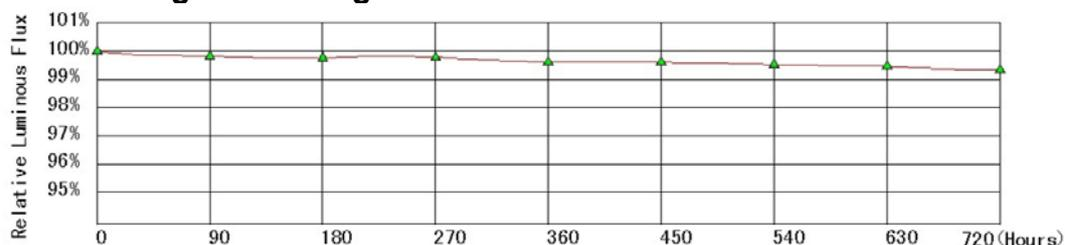
Aufgrund der ermittelten Daten eines beschleunigten Alterungstests über 720 Stunden mit extremen Temperaturschwankungen ist eine durchschnittliche Betriebsdauer von ca. 50000 Stunden zu erwarten. Der Lichtverlust liegt unter 1% je 1000 Stunden
