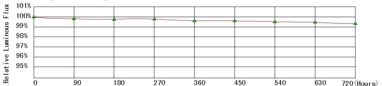
Aufgrund der ermittelten Daten eines beschleunigten Alterungstests über 720 Stunden mit extremen Temperaturschwankungen ist eine durchschnittliche Betriebsdauer von ca. 35000 Stunden zu erwarten. Der Lichtverlust liegt unter 1% je 1000 Stunden
