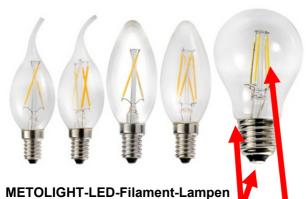
Verschweißte Sockel mit Lötkontakten Filamente auf Saphirträger, beidseitig beschichtet Edelgasgemisch, gute Kühlung IC-geregeltes Netzteil, hoher Leistungsfaktor Lange Haltbarkeit bis 20.000 h
