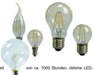
Die **METO**LIGHT<sup>®</sup> LED-Filament-Lampen sind mit einem Schutzgas gefüllt, das zugleich für die Kühlung der LED-Filamente sorgt. Daher werden auch keine Kühlkörper mehr benötigt und die Lampen können in den bisher gewohnten Formen gefertigt werden – als Globe, Tropfen, Kerze, Flamme oder Strahler mit Sockel E14 oder E27
