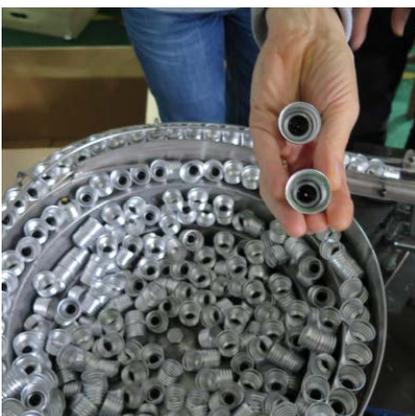
In die Gewindesockel wird maschinell eine Schweißpaste dosiert.
