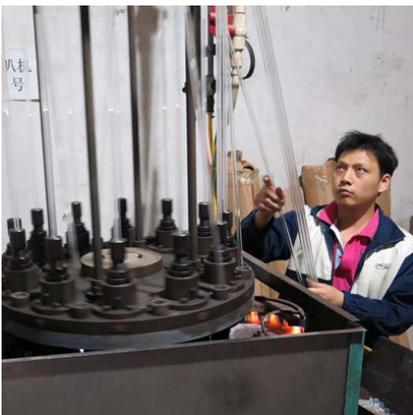
Zunächst werden die Glaskörper gefertigt und vorbereitet. Aus Glasstäben werden in entsprechenden Maschinen die inneren Träger für die LED-Filamente sowie die eigentlichen Glaskugeln in ihren verschiedenen Formen gefertigt.
