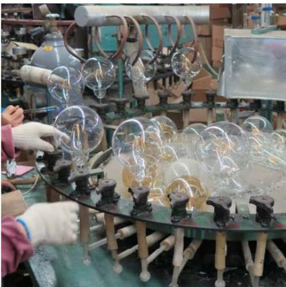
Im nächsten Schritt werden die vorbereiteten Lampen mit Edelgas befüllt und verschweißt.
