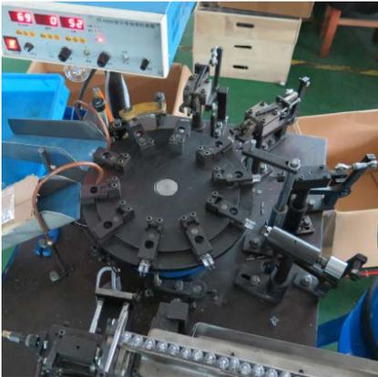
Die LED-Filamente mit Träger werden zunächst einzeln geprüft, die Kontaktdrähte werden ausgerichtet. Die Glasträger werden in die Glaskugel eingeschweißt
