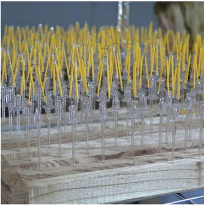
Links: Mit LED-Filamenten bestückte Glasträger vor dem Einbau in die Glaskugel.
