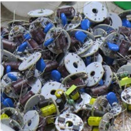
Der eingebaute LED-Treiber ist von ganz entscheidender Bedeutung für die Qualität der LED-Filamentlampen.
