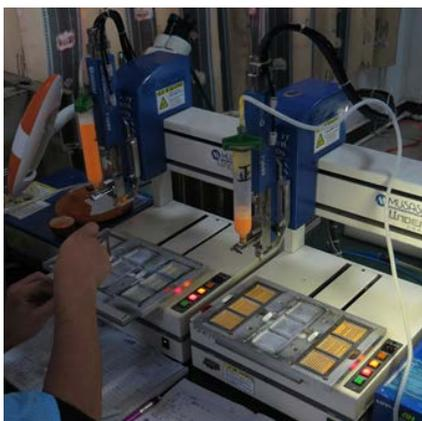
Nach diesem Fertigungsschritt werden die LED-Filamente in einem Automaten auf Funktion geprüft.
