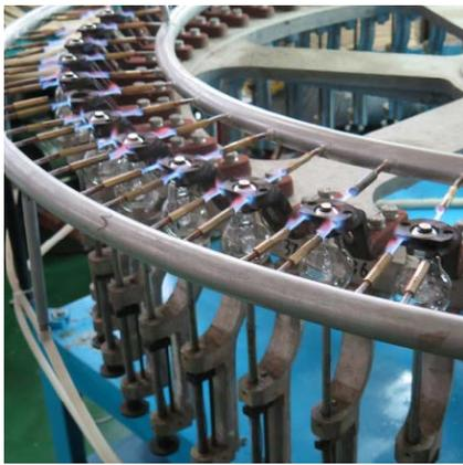
Anschließend werden nun die Gewinde-sockel auf die Glaskolben verschweißt, sowie die Kontakte an der Seite und am Sockelboden gelötet.
