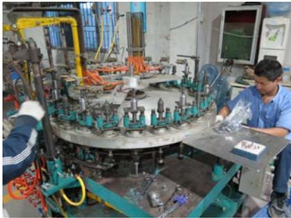
Die Umrüstung einer solchen Anlage auf eine andere Lampenform dauert bis zu 6 Stunden.
