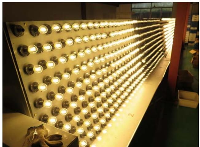
Jede METOLIGHT Filament-Lampe wird abschließend bedruckt und versandfertig verpackt.
