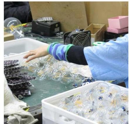
Die vielen einzelnen Funktionstests werden durchgeführt, um rechtzeitig defekte Lampen auszusortieren, damit diese nicht im weiteren Fertigungsprozess Zeit und Kosten verursachen. Zudem ist so die meist Verwendung der teuren LED-Filamente möglich.
