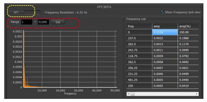
Lichtwelle im Frequenzbereich - JEITA (Japan Electronics Information Technology Association) uFlicker liefert die Intensität des dB-Werts für Lichtsignale unter 60 Hz. Mit genauen Messdaten können Sie Flimmern genauer überwachen.
