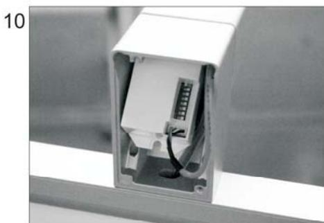
PIR-Sensor über DIP-Schalter einstellen
