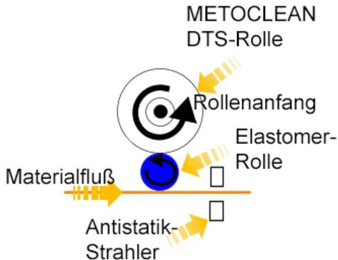
Der Papieranfang muss in Richtung der Laufrichtung des Materials zeigen, so dass beim Abrollen der Rollenanfang durch die Elastomerrolle immer angedrückt bleibt.
