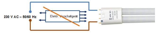
230 Volt-Anschluss an die beiden äußeren Pins
