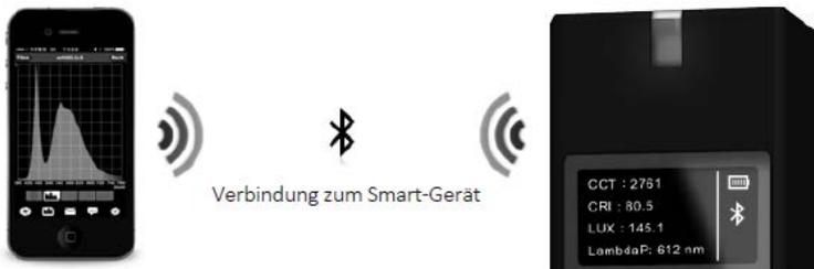
Mit einem Apple-IOS oder Android-Smart Gerät können Sie mit Hilfe einer Bluetooth-Verbindung das MK-350D fernsteuern.
